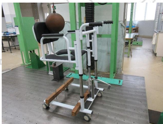
写真5 背支持部 後方衝撃試験状況
