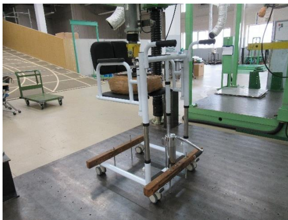
写真4 シート耐荷重試験状況
