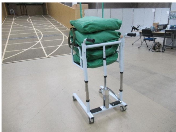
写真2 中央懸ちよう点の停止距離試験状況
